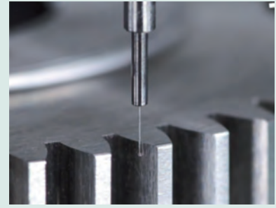
MPP-NANO module (0.8mm taster) met tandwiel meting
