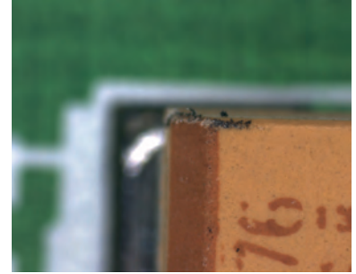
traditionele microscoop (boven) Met een hoogteverschil kan enkel op 1 hoogte gefocust worden.
