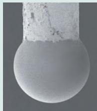
UMAP 110 ø100 µm L = 10 mm
