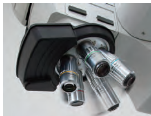
Optioneel 5 posities gemotoriseerde revolverkop
