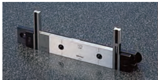
Houder B en C: Te gebruiken voor het koppelen van twee lange eindmaten samen met andere eindmaten tot 35 mm (houder B) of 140 mm (houder C). Ook te gebruiken voor het bevestigen van meetbekken met twee adapters.
