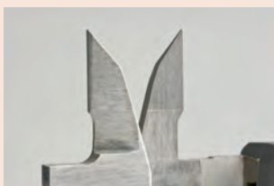
Meetbekken voorzien van hardmetaal
