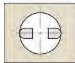
Afgeronde meetvlakken voor meting van binnen afmetingen
