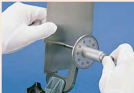
Serie 119 is voorzien van wijzer en wijzerplaat voor eenvoudige en snelle aflezing
