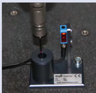
StyliCleaner, hogere nauwkeurigheid door schone tasters
